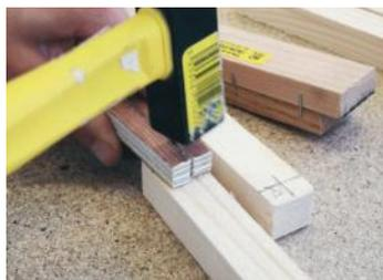
Sur D1 et D2, tracer avec le trusquin l'emplacement des clous. A ces emplacements, planter les clous avec le marteau. **La pointe du clou doit seulement dépasser de la planche.**
